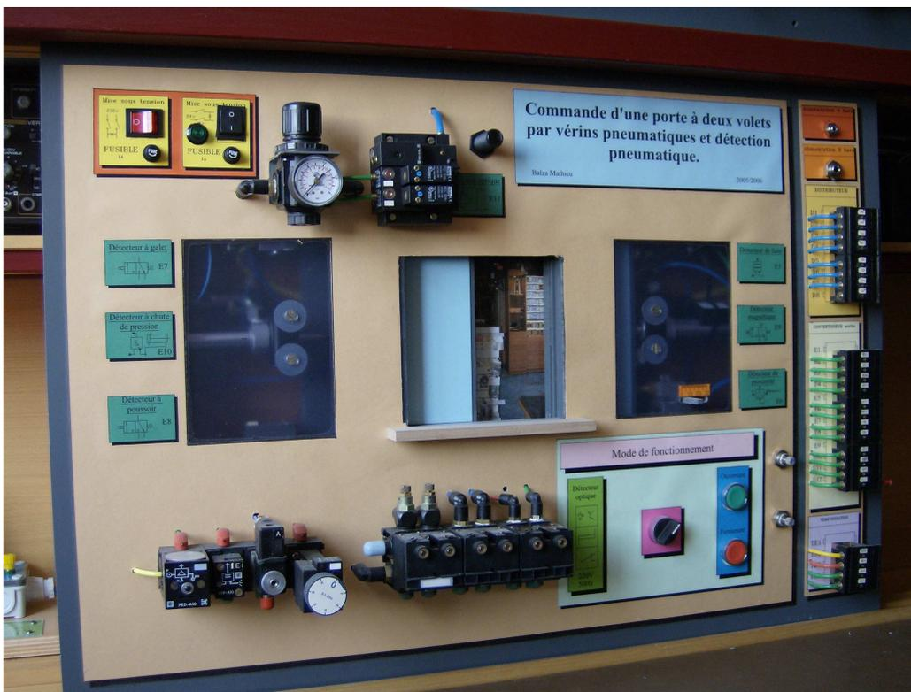
**Mise en situation n°9 : Unité de mise en mouvement de portes de magasin.**
